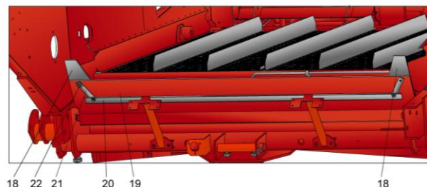
Контрпривод вариатора
