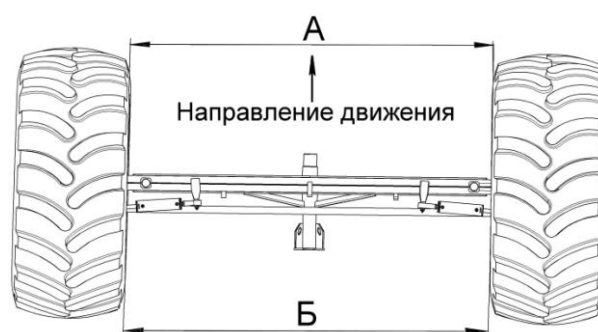
Рисунок 2.23 - Регулировка сходимости колес
