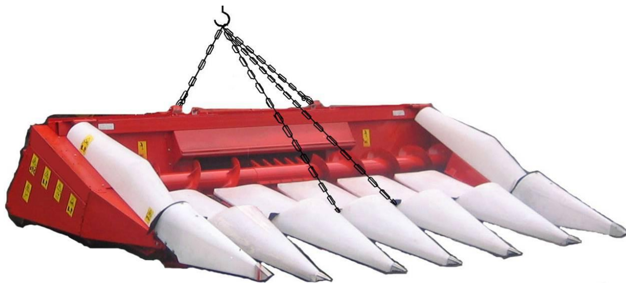
Рисунок 5.1 – Схема строповки жатки
