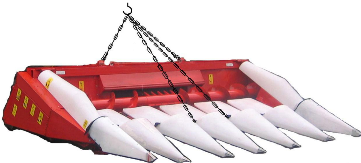
Рисунок 5.1 – Схема строповки жатки
